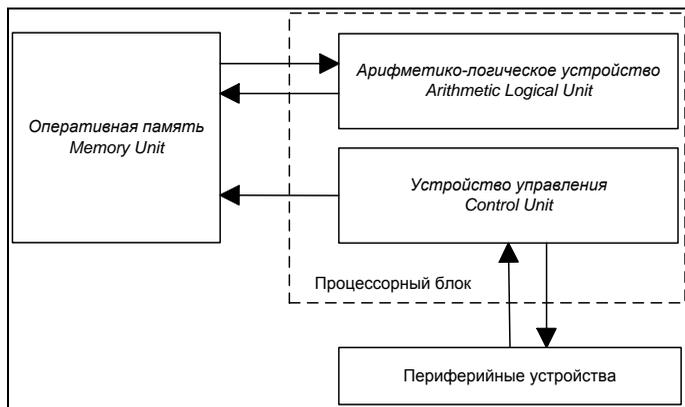
**Рис. 1.1. Элементы архитектуры фон Неймана**
